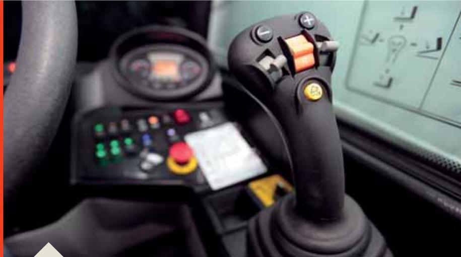
VNR-Tasten auf dem Joystick bieten maximale Kontrolle auf Knopfdruck. Die Auswahl der Fahrtrichtung erfolgt auf Knopfdruck, während die Hände am Lenkrad und auf dem Joystick verbleiben. Das sorgt für mehr Sicherheit und Produktivität.
