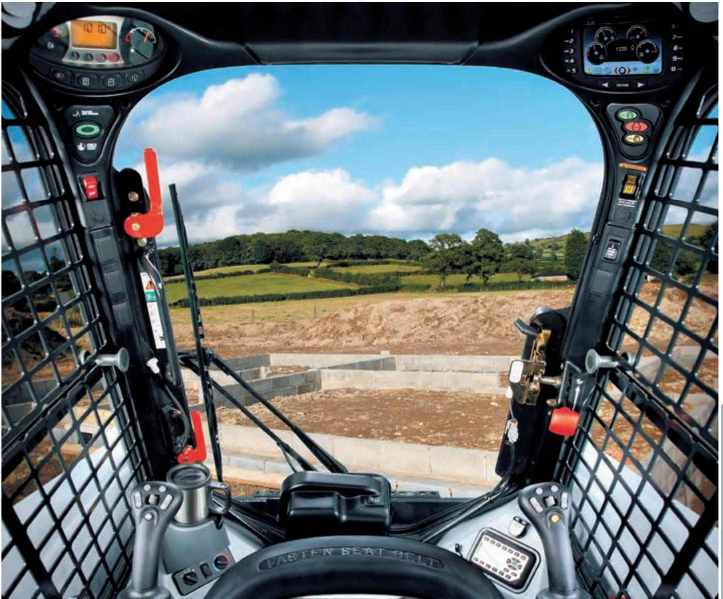
Bobcat Lader der neuen Generation sind mit einer wegweisenden Druckkabine ausgestattet. Diese verfügt über eine durchgängige Türdichtung, die in einer speziellen, gekrümmten Führung verläuft und dadurch Schmutz und Staub vom Innenraum fernhält. Der Geräuschpegel wurde verringert; dies sorgt für einen noch höheren Fahrerkomfort.
