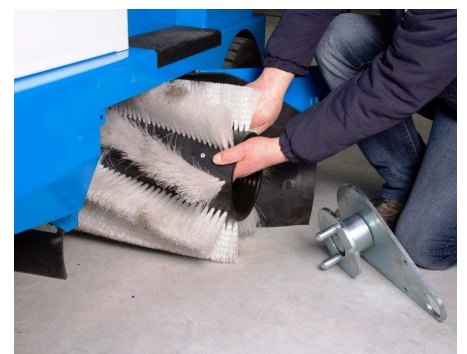
Hoher Qualitätsstandard für industriellen Einsatz. Höchste Effizienz, Wechsel der Hauptkehrwalze ohne Werkzeug spart Kosten und Zeit.
