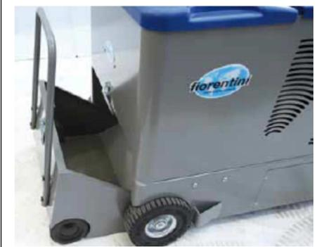
Heckseitig ausfahrbarer Kehrgutbehälter mit Haltebügel in Standard Version.
