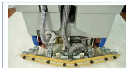
Industrieabsaugleiste für absolut trockenen Boden hinter der Maschine.
