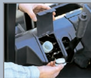
Bei zu geringem Bremsölstand leuchtet eine Lampe im Display auf.
