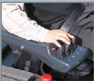
Mini-Hebel-Hydrauliksteuerventil, 3- oder 4-fach. (Option)
