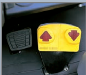
Mono-Pedal, für schnelle Richtungswechsel. (Option)
