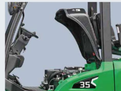
Die Haube kann in einem großen Winkel geöffnet werden, um die Wartung zu erleichtern.
