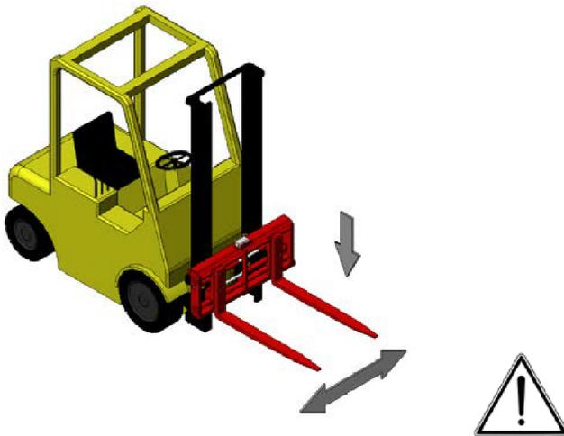
*Stellen Sie den Gabelabstand so breit wie möglich ein, um eine größtmögliche Stabilität der Kiste oder Palette zu gewährleisten und transportieren Sie die Ladung mit dem Gabelverstellgerät in möglichst weit abgesenkter Position.*
