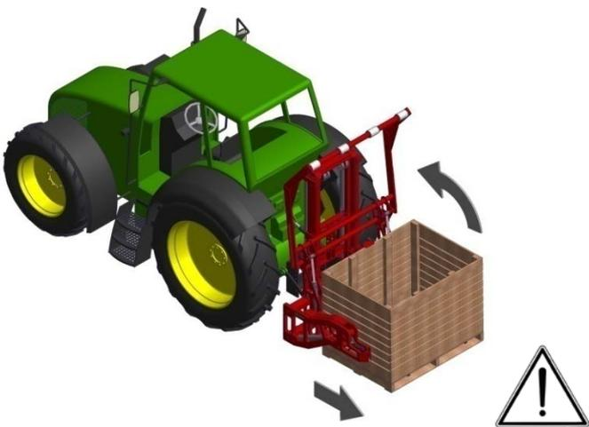
*Stellen Sie die Oberklemme mit dem Klemmzylinder hoch, bevor die Kiste mit dem Vornüber-Drehgerät aufgenommen wird.*
