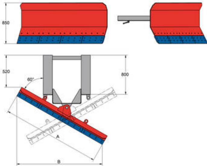
mechanisch schwenkbar - Einfahrtaschen für Gabelzinken, zum Räumen nach rechts und links umsteckbar
