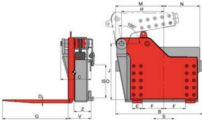
mit Seitenschub - Kippwinkel  $\alpha = 100^\circ$  nach rechts - 2 Hydraulikfunktionen
