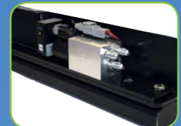
Hydraulik-Funkfernbedienung als einfaches und preiswertes System zur Einstellung der Gabelposition
