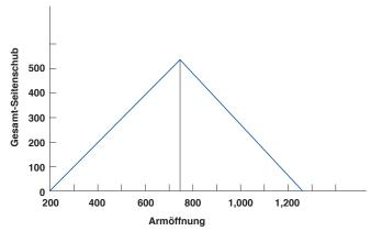
Der Gesamt-Seitenschub ist von der aktuellen Armposition abhängig. Vollständig geöffnet oder geschlossen; KEIN Seitenschub.
