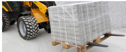
Der 3450 S kann Paletten von 2,0 t verfahren. Ein schmaler und sehr niedriger Vorderwagen optimiert die Sicht des Fahrers auf das Werkzeug.
