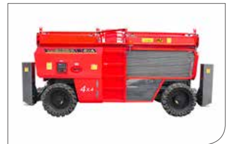
Klappbares Geländer: praktisch für das Lagern, den Transport und das Durchfahren von beengten Platzverhältnissen
