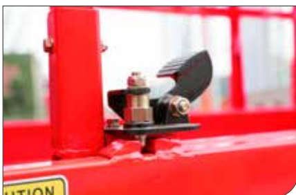
Pedalverriegelung des Plattformausschubs
