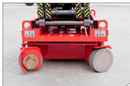
Null-Grad-Wenderadius durch Gleichstrommotoren mit Stahlabdeckung
