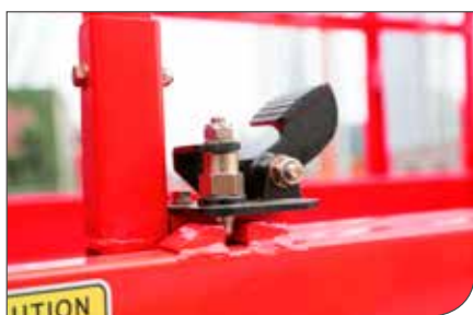
Pedalverriegelung des Plattformausschubs
