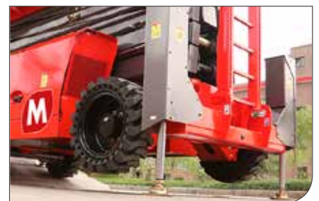
Hydraulische Stützen mit automatischem Niveaue Ausgleich
