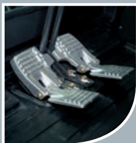
Die neuen, ergonomisch gestalteten Aluminium Fahrpedale sorgen für eine feinfühligere und sichere Bedienung der Maschine.
